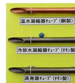
熱源機伝熱管
