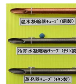
熱源機伝熱管
